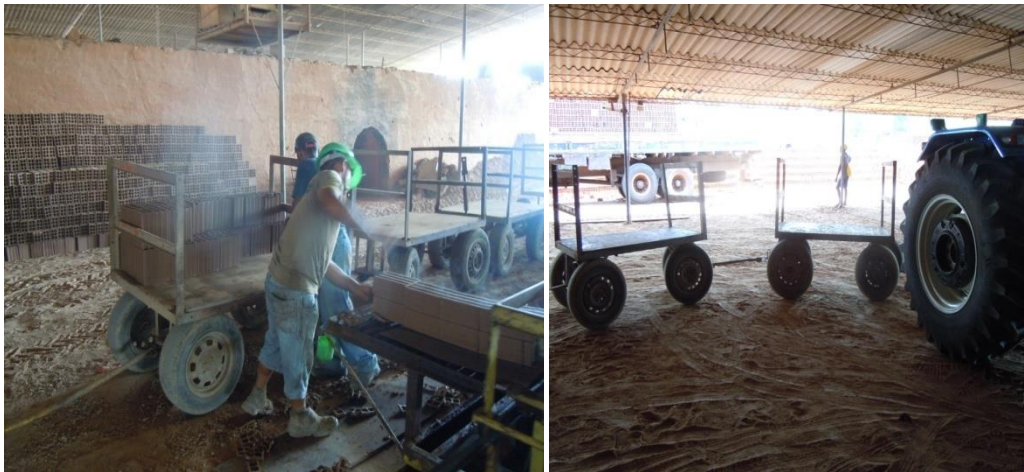
Figura 4.17 - Empilhamento dos tijolos nos carrinhos e transporte por trator agrícola.
