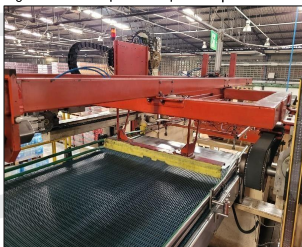
Figura 4.8 - Transportador após despalletizadora.
