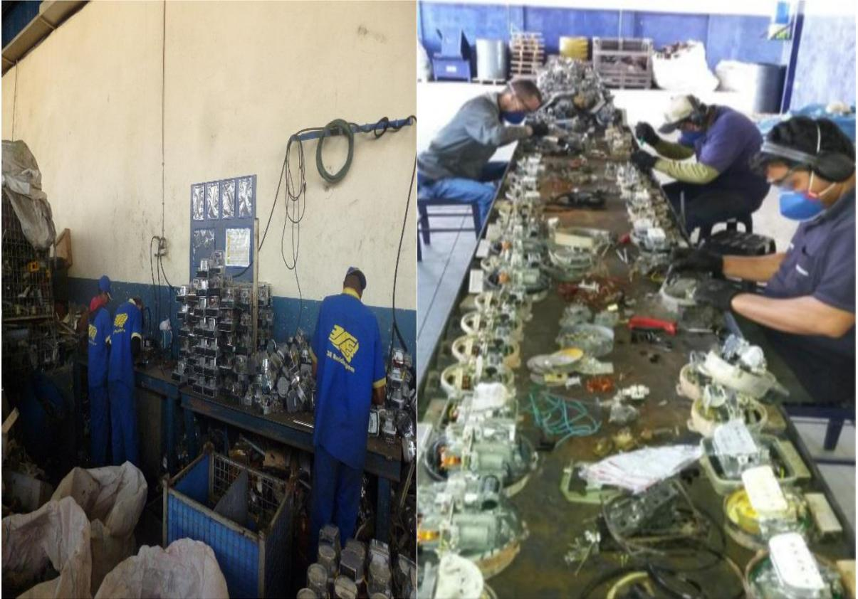
**Figura 4.4** Processo de desmontagem dos medidores.
