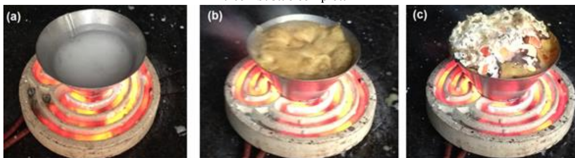
Figura 2 – Etapas da obtenção da HAp por reação de combustão. (a) Aquecimento da mistura dos reagentes na resistência, (b) liberação dos gases provenientes da combustão e (c) pós da HAp obtido após a combustão completa.
