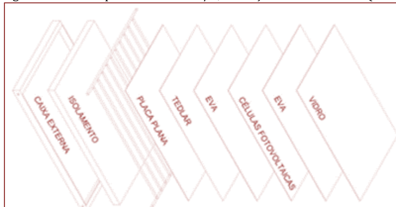
Figura 3 – Vista explodida de um PV/T, alteração FERREIRA et al (2014)
