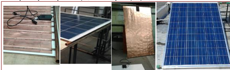
Figura 1 – Exemplo de protótipo de PV/T, antes e após a junção, construído e em fase de testes.
