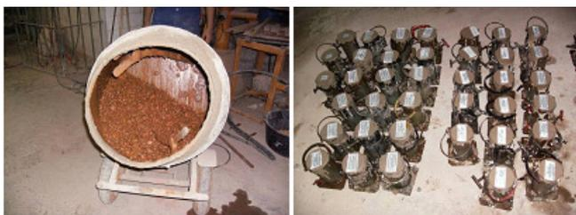
Figura 3 – Moldagem dos corpos-de-prova
