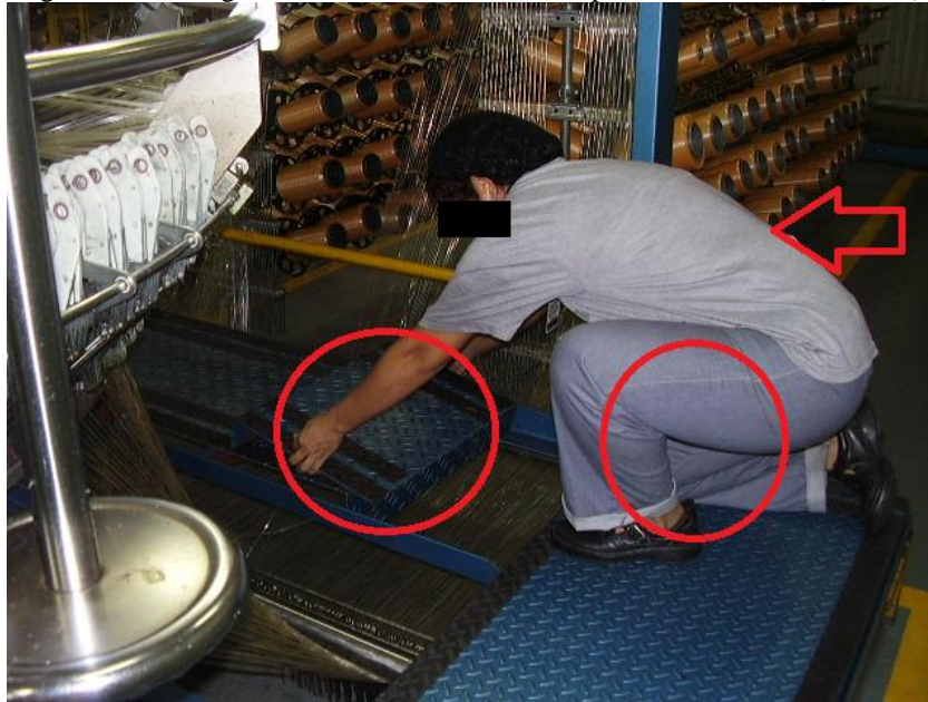
Figura 15 - Passagem das fibras da matriz sob o piso falso de ferro (Posto 2).
