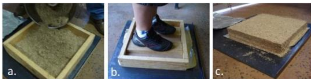
Figura 3.19 .Etapas de pré-moldagem: a) Moldagem, b) pré-prensagem e c) formação do colchão de açaí e resina.
