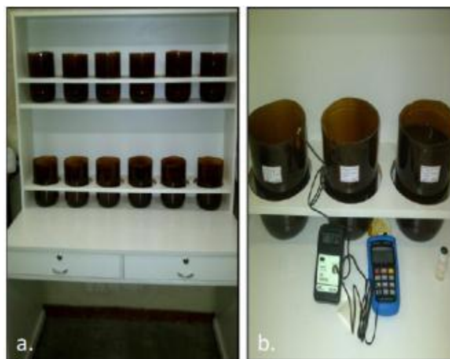
Figura 3.7. Protótipo de mercerização (a) Tanques de mercerização (b) Instrumental utilizado nas medições. Fonte. Autor
