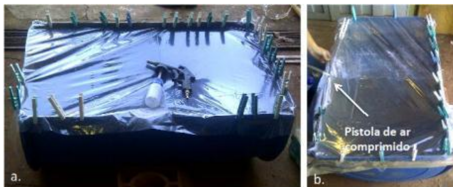
Figura 3.18. Homogeneização mecânica (a) Tambor de PVC e pistola de ar comprimido (b) Aplicação de resina.
