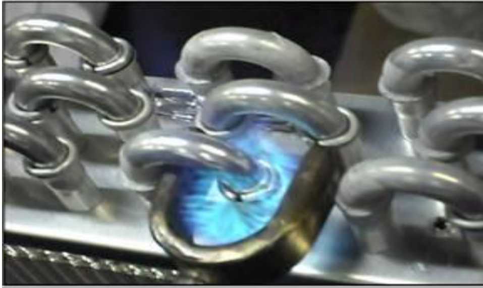
Figura 4.56 - Teste experimental da plataforma experimental na brasagem do trocador de calor
