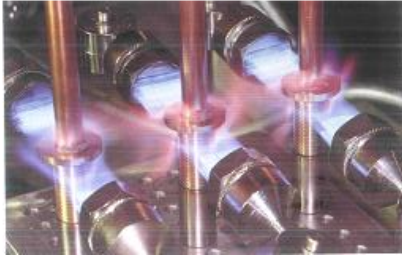
Figura 2.12 - Máquina automática de brasagem peças de latão com queimadores tipo jato ar/gás de alta pressão. Fonte: http://www.nei.com.br
