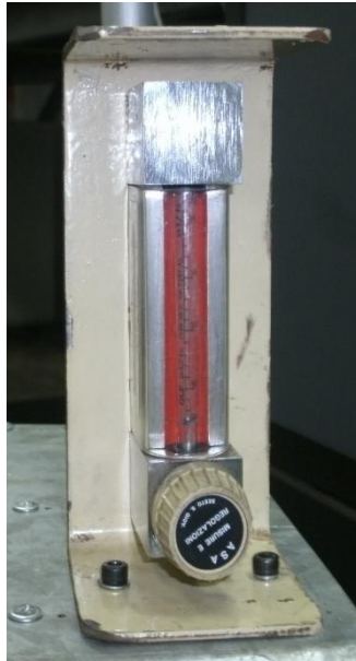
Figura 3.6 - Rotâmetro de controle de vazão de gás GLP.
