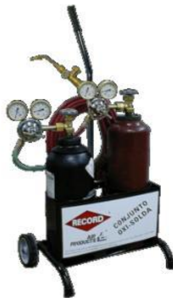
Figura 2.9 - Esquema de um maçarico para brasagem com queimador que utiliza como oxidante o oxigênio. Fonte: www.gasflux.com.br
