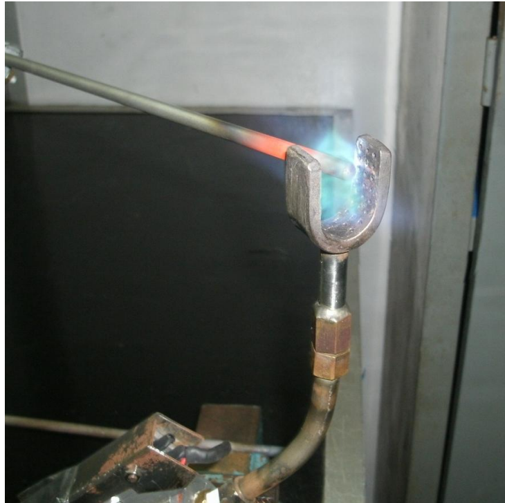
Figura 3.21- Medição da temperatura de chama termopar tipo k com queimado com formato de U.
