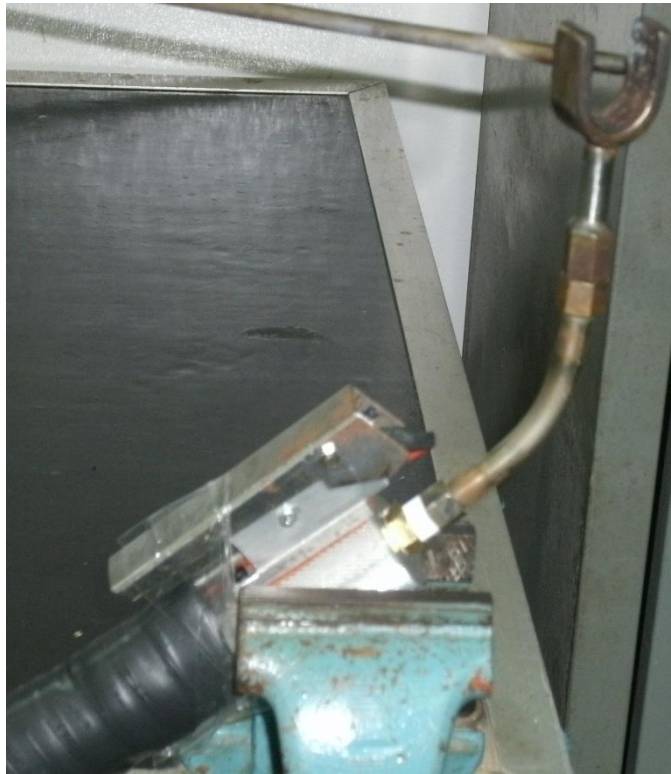
Figura 3.12 - Queimador Tipo U montado nos punho suporte na posição de teste.
