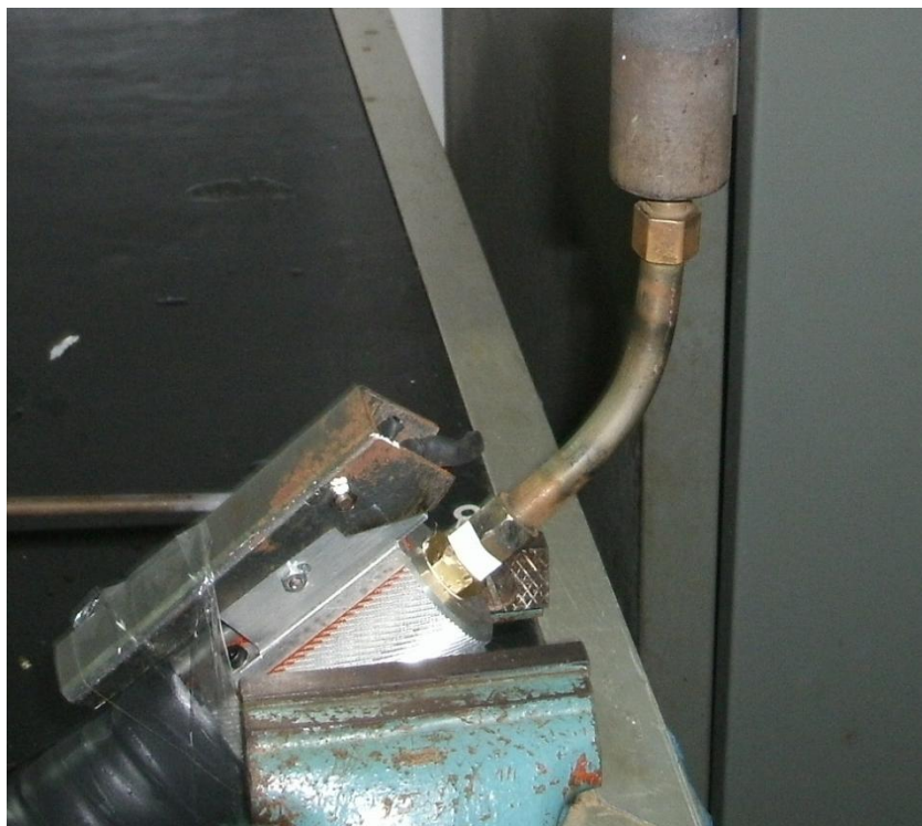
Figura 3.10 - Queimador cilíndrico instalado no punho suporte na posição de teste.
