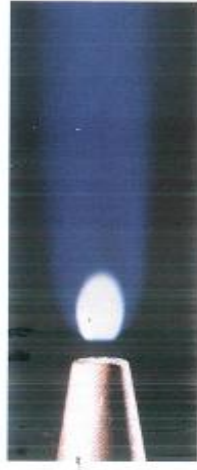
Figura 2.2 - Chama desestabilizada na borda do tubo conhecida como blow off .
