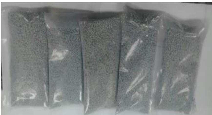
Figura 4.12 - Foto da diferença de cor na resina PET-PCR.
