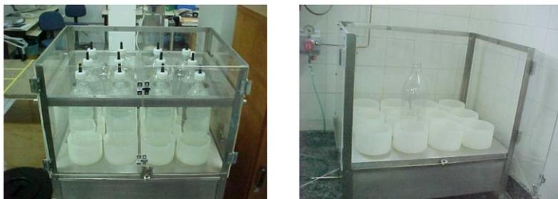
Figura 3.6 - Dispositivo do teste de stress cracking.
