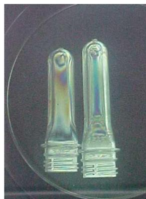
Figura 3.3 - Dispositivo com luz natural e polarizada para teste visual.
