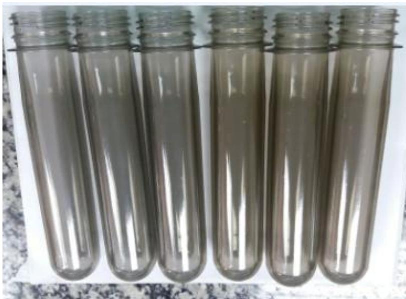
Figura 4.11 - Foto da diferença de cor das pré-forma PET-V e PET-PCR.
