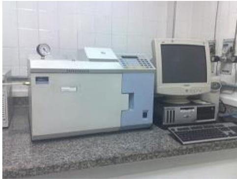
Figura 3.2 - Equipamento Perkinelmer para análise de AA.
