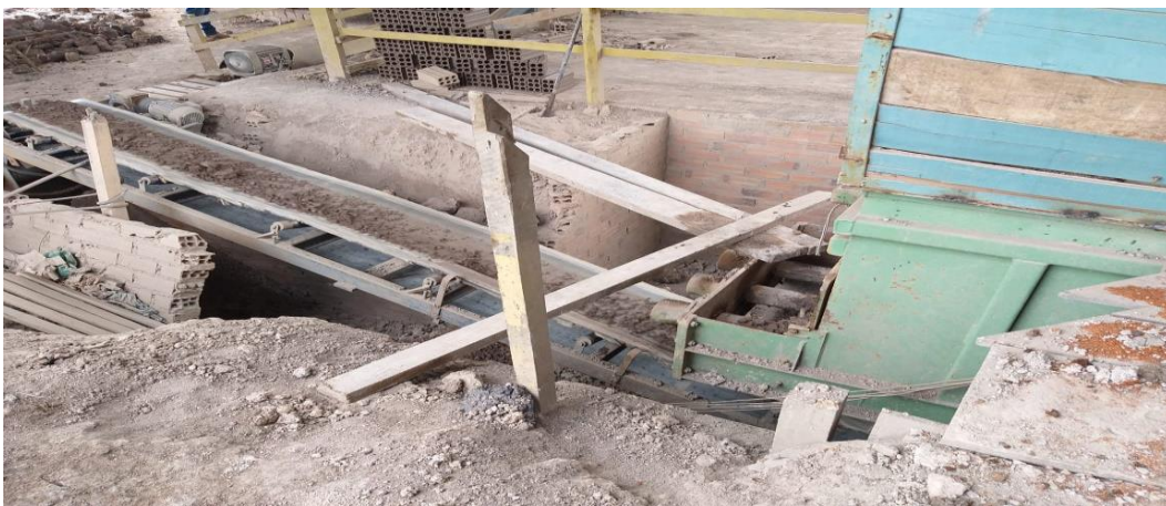
Figura 4.4 - Esteira de transporte da matéria-prima.
