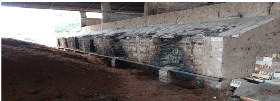
Figura 4.15 - Local da queima exposto com a serragem usada na alimentação da fornalha.
