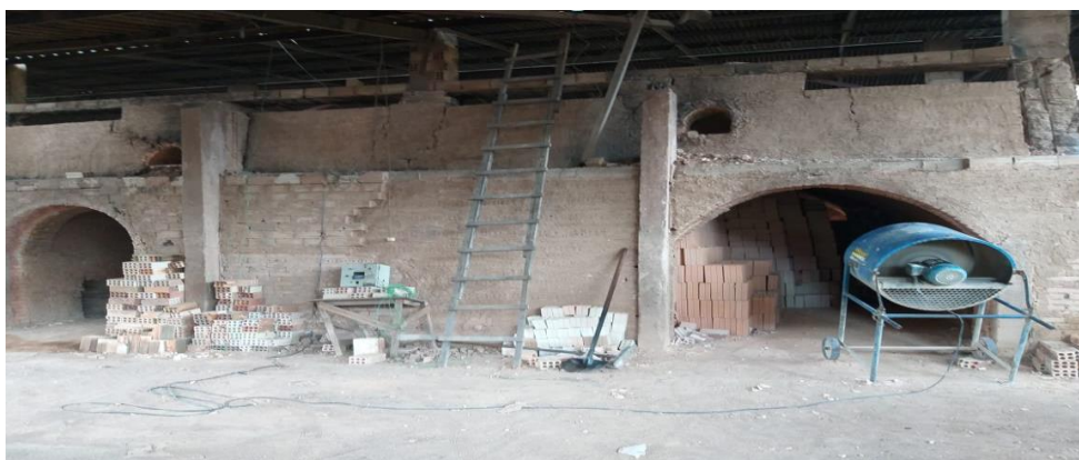
Figura 4.12 - Ventilador para ajudar no processo de resfriamento.
