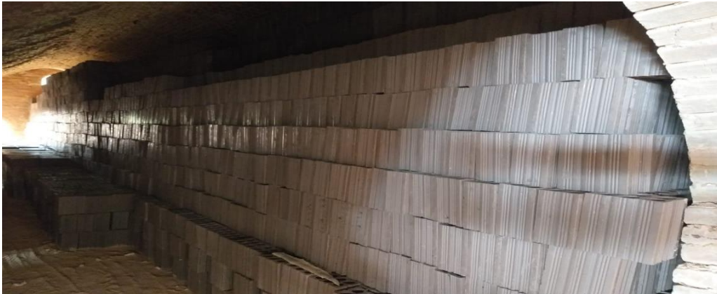
Figura 4.11 - Início do processo resfriamento após a queima.
