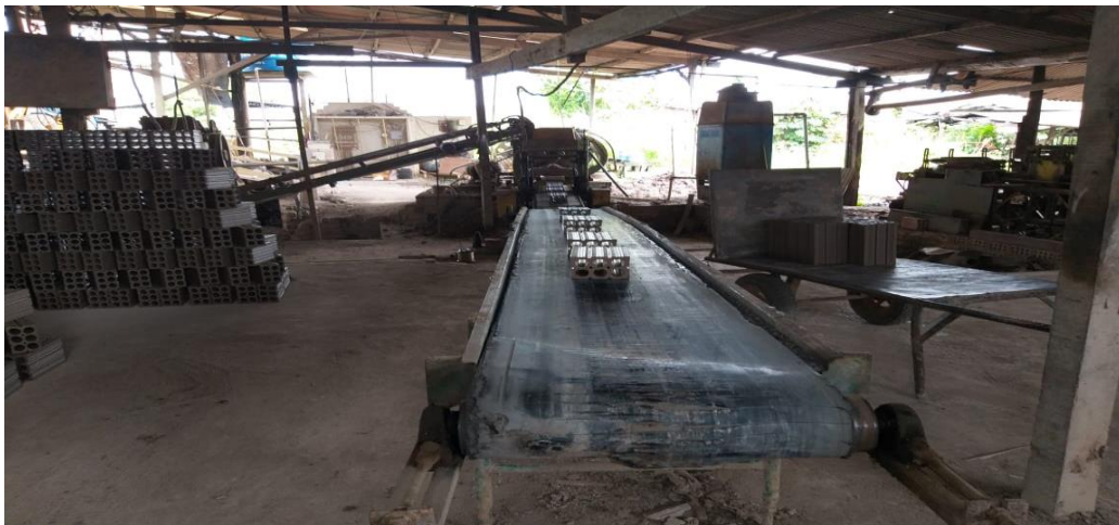
Figura 4.7 - Esteira de transporte do tijolo.
