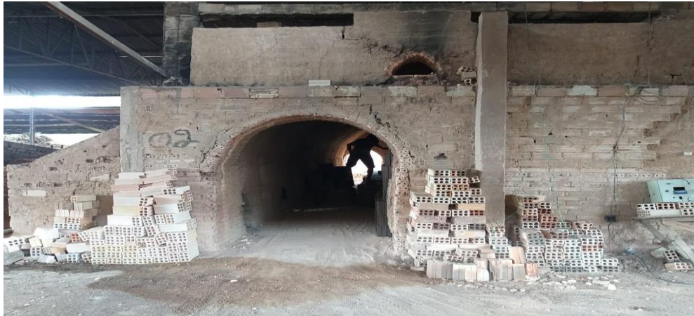
Figura 4.13 - Forno sendo preparado para queima.
